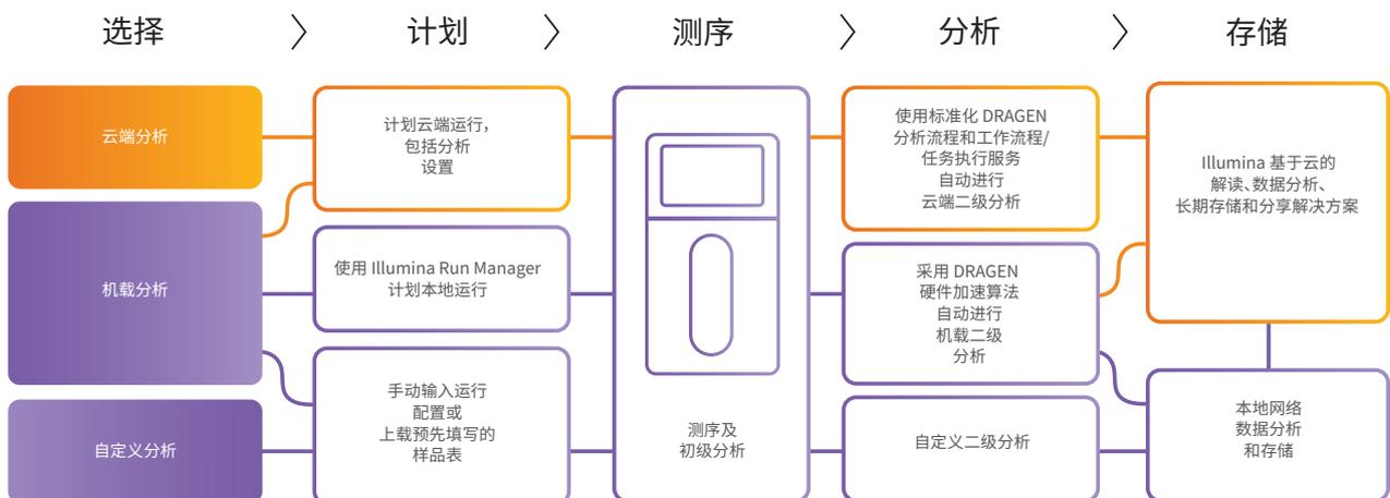
图 6: 灵活的信息学套件 — NextSeq X 和 NextSeq X Plus 系统提供了本地 (紫色) 和云端 (橙色) 的运行设置、运行管理和数据分析选项, 可让用户按自己的方式运行测序。
