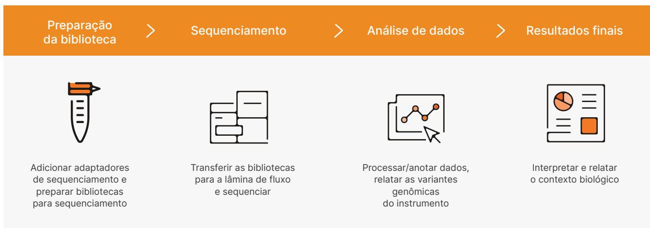
Figura 2: Fluxo de trabalho do MiSeq System; o fluxo de trabalho simplificado do MiSeq System permite um tempo rápido de resposta para sequenciamentos de bancada de última geração. As bibliotecas podem ser preparadas com qualquer kit de preparação de bibliotecas compatível. O tempo de sequenciamento de cinco horas e meia inclui clusterização, sequenciamento e identificação de bases com pontuação de qualidade com leitura em superfície dupla para uma execução de 2 × 25 pares de base em um MiSeq System com MiSeq Control Software.
