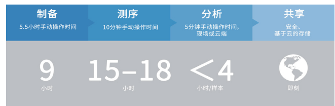
图 2 : NextSeq 550 系统工作流程 - NextSeq 550 系统提供从样本制备到数据分析的简单、集成的工作流程。工作流程时间可能依实验和分析方法类型的不同而有所差异。图中显示的详情以使用 2×75 bp 对 mRNA 表达谱进行测序为例。分析结果包括差异表达和选择性转录本的鉴定。
