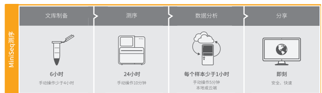
图2: MiniSeq系统的测序流程 - MiniSeq系统提供了一个简单且集成的、从文库制备到数据分析的工作流程。根据实验和检测类型的不同，流程时间也有差异。图中显示了在仪器上开展2 x 150 bp测序的条件下，TruSeq® Custom Amplicon测序实验的详细情况。
