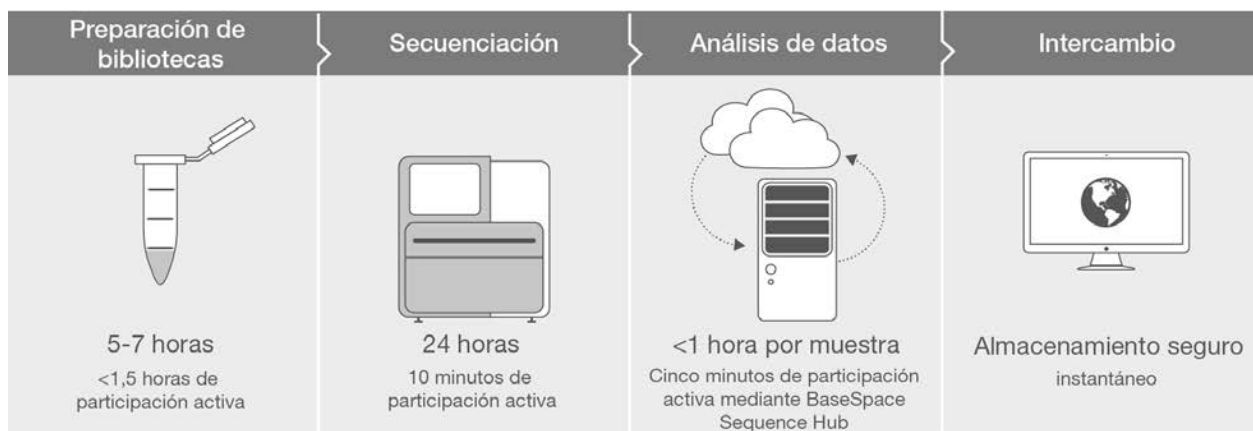
Figura 2: Flujo de trabajo de secuenciación del sistema MiniSeq: El sistema MiniSeq proporciona un flujo de trabajo de secuenciación sencillo e integrado que abarca desde la preparación de las bibliotecas hasta el análisis de los datos en el instrumento. Los tiempos del flujo de trabajo variarán en función del tipo de ensayo y de experimento. Los detalles mostrados son de un experimento de secuenciación en el que se utiliza la solución de secuenciación AmpliSeq™ para Illumina y una longitud de lectura de 2 × 150 pb.
