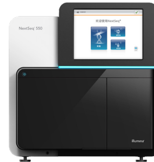
图 1 : NextSeq 550 系统 - 利用 SBS 测序化学和用户友好工作流程的最新进展，NextSeq 550 系统为外显子组、转录组和靶向重测序等应用提供高质量的结果。
